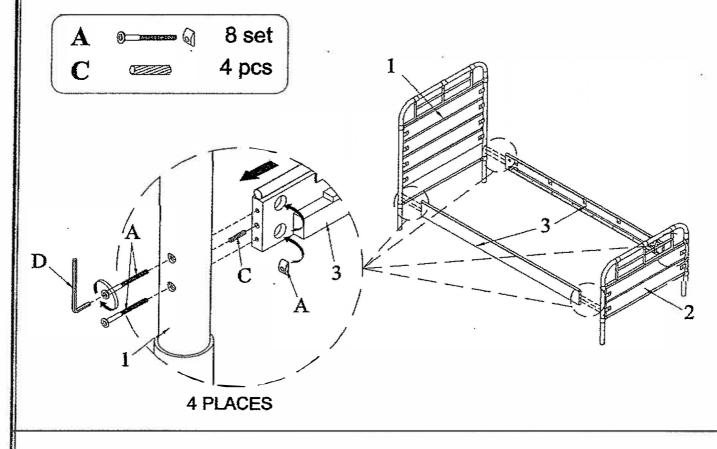
**STEP 2:** COMPLETED TWIN SLAT ASSEMBLY
