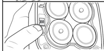
A) Coloque 4 pilas de celdas D. Asegúrese de que las pilas estén colocadas de manera tal que los extremos lisos hagan contacto con los resortes. B) Elija una zona\* para sus lámparas con los interruptores DIP junto al compartimento de las pilas. Asegúrese de que todas las unidades estén en el mismo canal y, para ello, coordine las posiciones de los interruptores DIP en cada lámpara.
