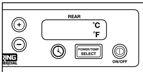
estar en blanco). Mantenga oprimido el botón POWER/TEMP SELECT durante 3 segundos. Las unidades de temperatura C° y F° aparecerán en la pantalla. La unidad de temperatura actual parpadeará. Utilice los botones +/- para cambiar la unidad de F° a C° o viceversa. Cuando la unidad de temperatura deseada empiece a parpadear, oprima el botón POWER/TEMP SELECT para confirmar, y luego el botón ON/OFF.
