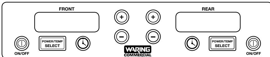
**NOTA:** cocinar sobre una placa de inducción requiere cacerolas/ ollas aptas para inducción. La placa no funcionará con cacerolas/ ollas no aptas para inducción. Si intenta usar una cacerola/olla no apta para inducción, "STANDBY" aparecerá en la pantalla. La placa se apagará automáticamente después de 60 segundos.
