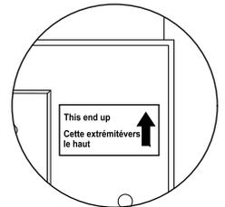
UNE FOIS LE LUMINAIRE MONTÉ, CALFEUTREZ L'ESPACE ENTRE LE MUR ET LES 3/4 DU HAUT DE LA PLAQUE MURALE POUR EMPÊCHER L'EAU DE RENTRER DANS LE BOÎTIER. LAISSEZ LE QUART D'EN BAS NON-CALFEUTRÉ POUR L'ÉVACUATION D'EAU QUI PEUT ÉVENTUELLEMENT PÉNÉTRER DANS LE BOÎTIER.
