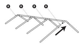
STEP 4 ASSEMBLE BOTH LOWER EAVE SUPPORTS
