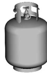
Tanque de LP en posición vertical para extracción de vapor
