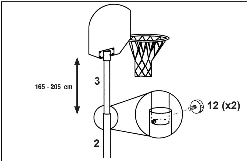
Desserrez les boulons du bouton (12) pour régler la hauteur.
