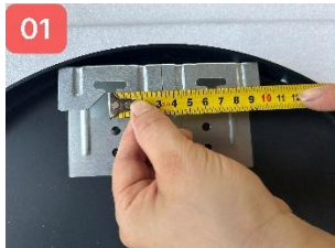
测量挂钩中心点孔距
