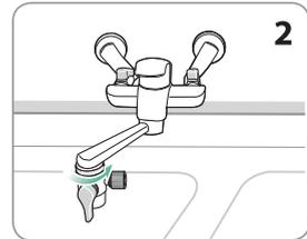
3. Conecte la manguera de entrada en la conexión de entrada debajo de la base. A continuación, conecte el otro extremo de la manguera al grifo desviador.
