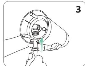
4. Conecte la boquilla proporcionada al orificio de salida. Asegúrese de presionar completamente.
