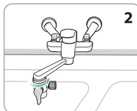
3. Raccordez le tuyau d'alimentation au raccord d'entrée sous la base. Branchez ensuite l'autre extrémité du tuyau à la dérivation du robinet.
