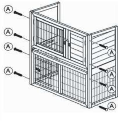
**2. Verschrauben Sie die Rückwände mit den Seitenteilen.**
