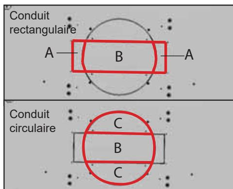
8. Enlevez les entrées défonçables A et B pour installer un conduit rectangulaire. Enlevez les entrées défonçables B et C pour installer un conduit circulaire.
