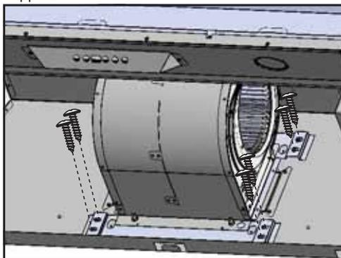
13. Fixez le ventilateur aux écrous captifs de l'intérieur de la paroi arrière du boîtier à l'aide de (8) vis 3/16" x 3/8", soit (4) vis pour chaque support. Scellez tout espace autour de la plaque de l'entrée défonçable avec du ruban à conduit en aluminium. Branchez le connecteur Molex.
