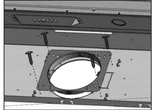
10. (Conduit circulaire) À partir de l'intérieur du boîtier, installez l'adaptateur circulaire de 8" dans l'entrée défonçable arrière et fixez-le à la paroi intérieure arrière du boîtier à l'aide de (4) vis M4 x 6 mm.
