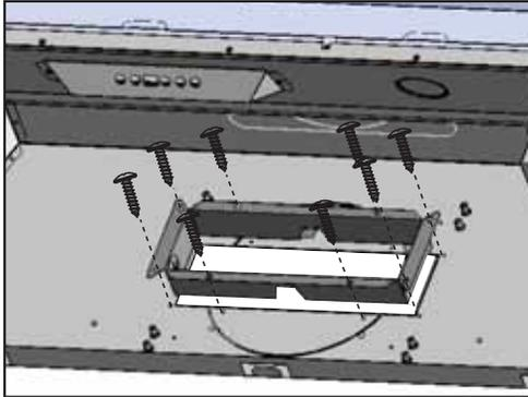
10. (Conduit rectangulaire) À partir de l'intérieur du boîtier, installez l'adaptateur rectangulaire de 3-1/4" x 10" dans l'entrée défonçable arrière et fixez-le à la paroi intérieure arrière du boîtier à l'aide de (8) vis M4 x 6 mm.
