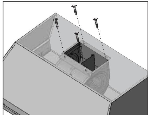
6. Enlevez le ventilateur du boîtier en retirant les (4) vis 3/16" x 3/8" de la partie supérieure du boîtier. Gardez les vis de côté pour une utilisation ultérieure.
