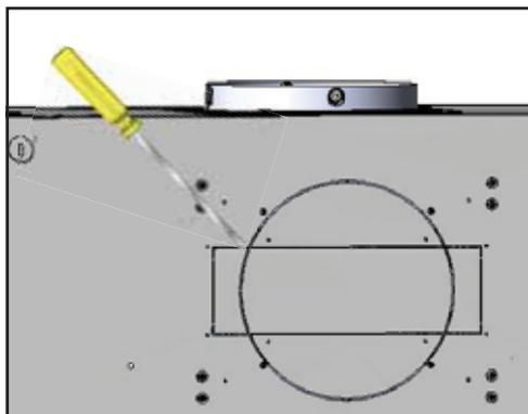
7. À l'aide d'un tournevis plat, enlevez l'entrée défonçable circulaire de 8" ou l'entrée défonçable rectangulaire de 3 1/4"x10", toutes deux situés à l'arrière du boîtier.
