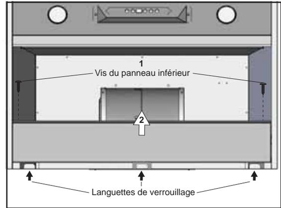
4. Enlevez le panneau inférieur de la façon suivante : (1) Enlevez les (2) vis des deux côtés du panneau inférieur. (2) Tirez le panneau inférieur vers l'avant du boîtier pour le libérer des languettes de verrouillage.
