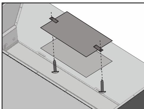
9. Placez la plaque supérieure rectangulaire sur l'ouverture du boîtier. NOTE : Assurez-vous que les languettes de la plaque se trouvent sur le dessus de la plaque, comme illustré. Fixez la plaque sur le dessus du boîtier à partir de l'intérieur à l'aide des (2) vis 3/16 x 3/8.
