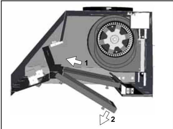
1. Enlevez les filtres déflecteurs de la façon suivante : (1) Tirez le filtre vers l'avant du boîtier. (2) Faites pivoter l'arrière du filtre vers le bas.
