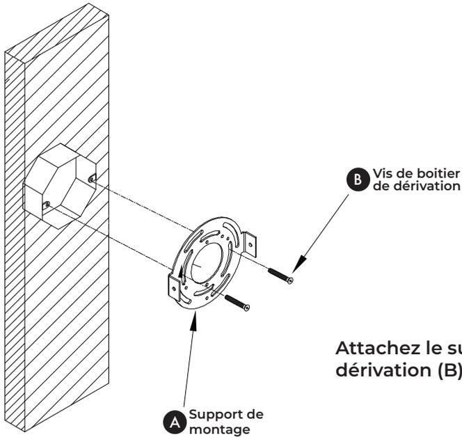
Attachez le support de montage (A) avec les vis de boîtier de dérivation (B).
