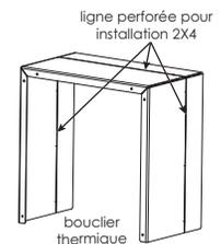
1. En tenant compte des dégagements minimaux mentionnés dans le tableau 2, localisez le montant du mur le plus proche (qui servira à tenir l'appareil) et marquez le centre du trou carré à une distance «A» (si le montant du mur est à droite) ou «B», (si le montant est à gauche) (voir le tableau 2 et les figures 7 et 8). Remarque: Utilisez l'écran thermique pour maintenir le support en place lors du marquage des emplacements des trous carrés.
