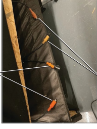
FIGURE 7 Connecteur de l'appuie-tête réglable (gris ou orange)
